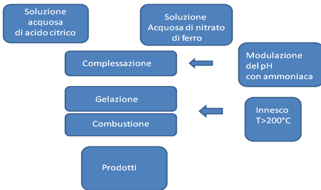
Figura 2. Diagramma a blocchi per la sintesi dell'ossido di ferro secondo il processo sol gel di autocombustione.
